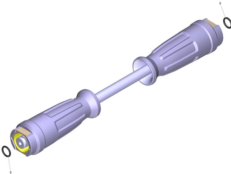
61 Schlauchleitung TR DN6 25MPa 10m (6.110-034.0)
