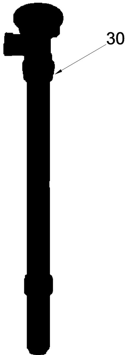
10 Pumpenrohrsatz fuer Fasspumpe kpl. (9.988-295.0)
