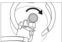
→ Gasentnahmeventil durch Drehen im Uhrzeigersinn schließen.
