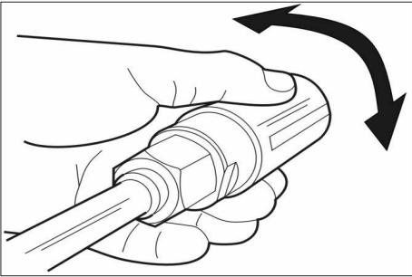
→ Регулюйте положення пінного струменя шляхом повороту корпуса форсунки.
