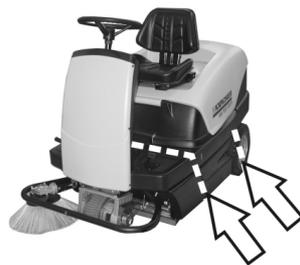
**Hinweis:** Markierungen für Befestigungsbereiche am Grundrahmen beachten (Kettensymbole). Das Gerät darf zum Auf- oder Abladen nur auf Steigungen bis max. 18% betrieben werden.
