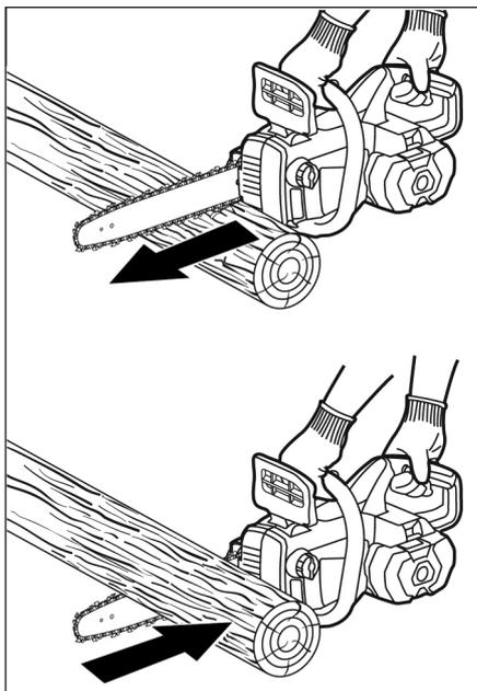
Beim Hineinziehen wird die Kettensäge ruckartig zum Sägegut gezogen.
