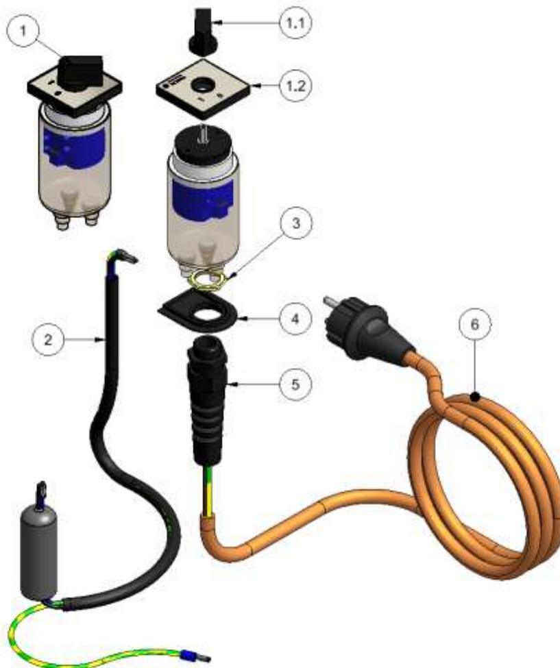
12.7.1 Explosionszeichnung Einstufenschalter mit Kabelsatz W1G / W1E
