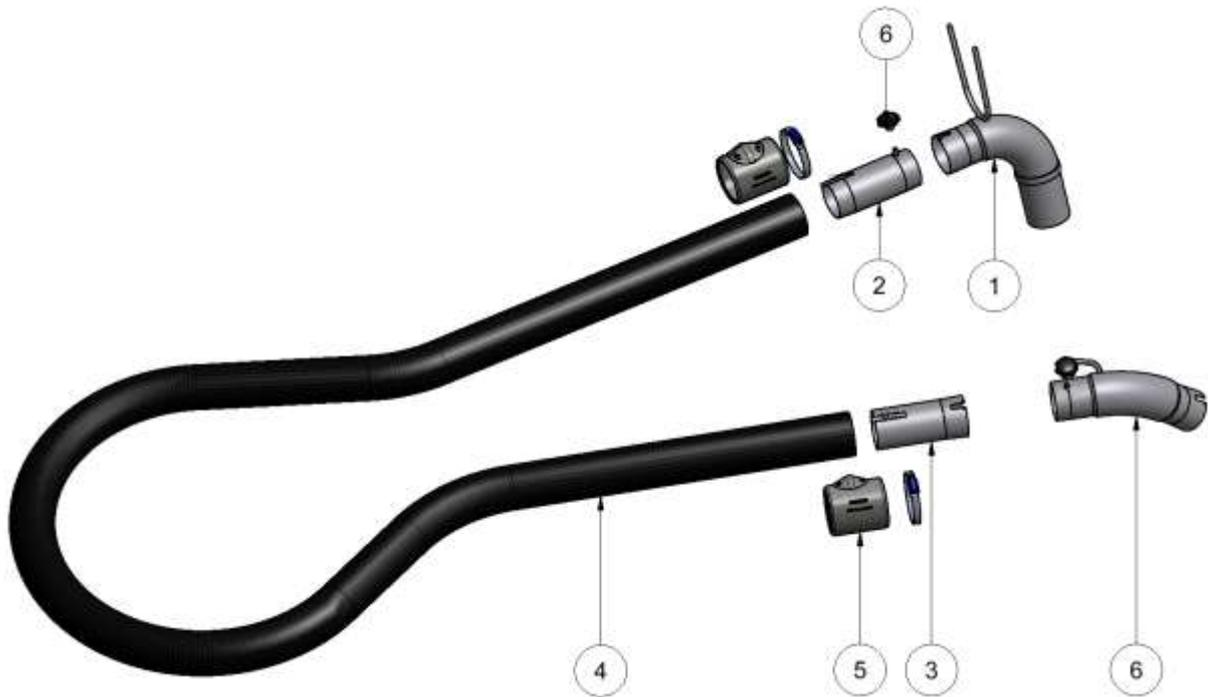
**12.14.1 Ersatzteilliste Saugschlaucheinheit DN 70, alle Typen**
