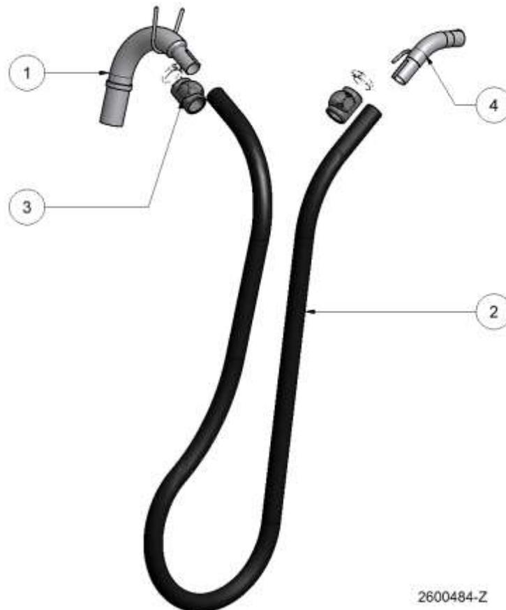
**12.10.1 Ersatzteilliste Saugschlaucheinheit DN 40, alle Typen**
