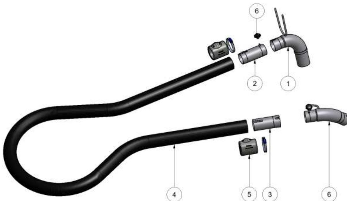
12.18.3 Ersatzteilliste Saugschlaucheinheit DN 70, alle Typen
