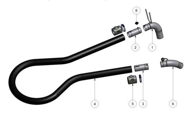
12.12.1 Ersatzteilliste Saugschlaucheinheit DN 70, alle Typen
