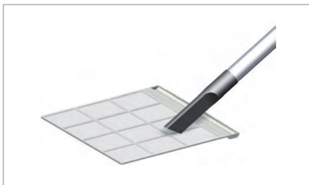
Abb. 18: Reinigung mit dem Staubsauger
