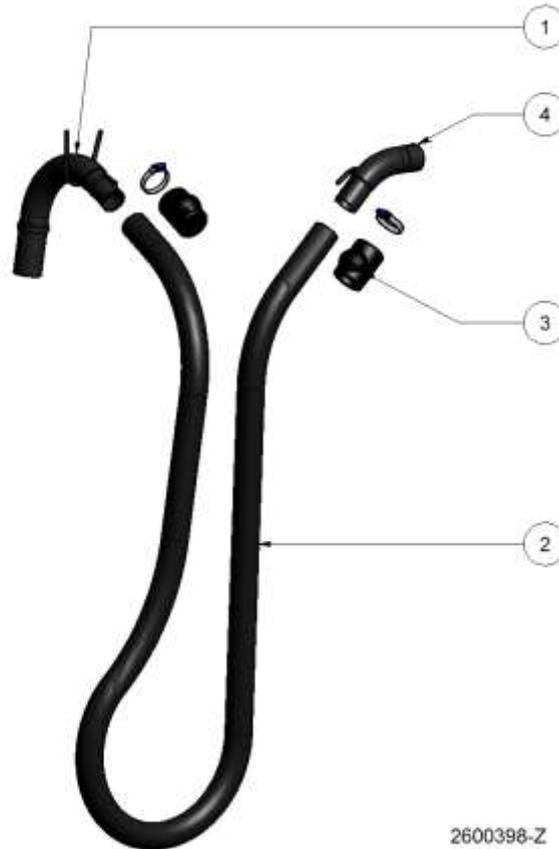
12.15.1 Ersatzteilliste Saugschlaucheinheit DN 50, alle Typen
