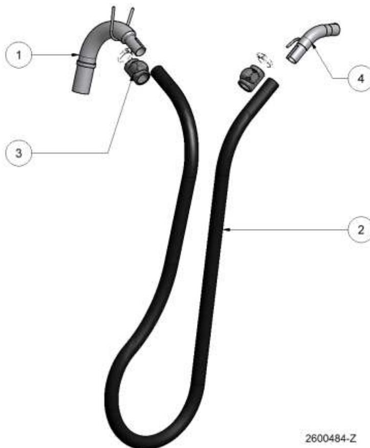
**12.14.1 Ersatzteilliste Saugschlaucheinheit DN 40, alle Typen**
