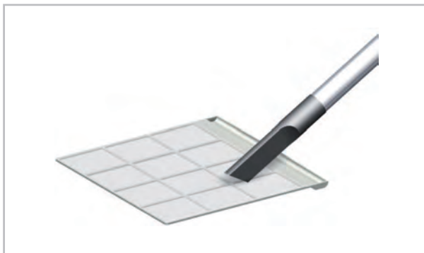
Abb. 16: Reinigung mit dem Staubsauger
