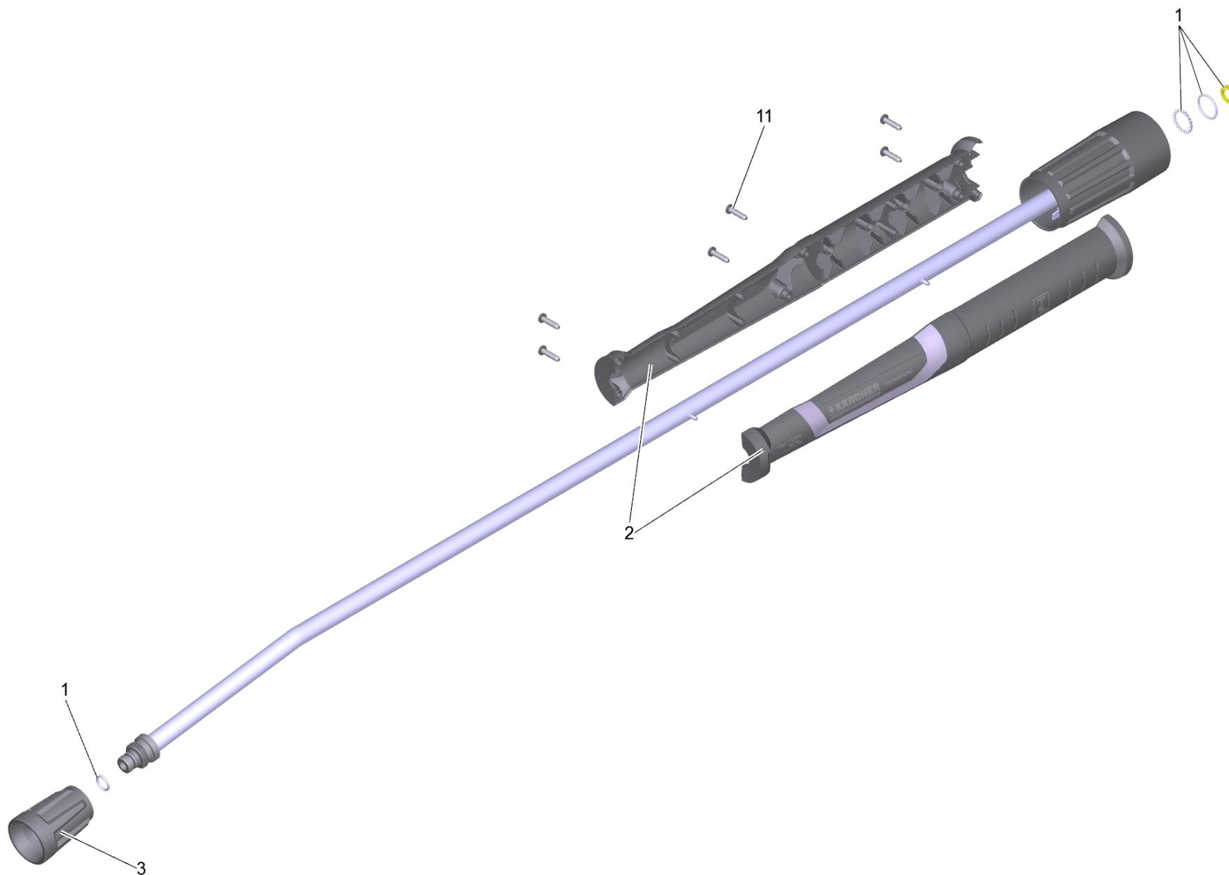
906 Strahlrohr TR 1050 mm (4.112-000.0)
