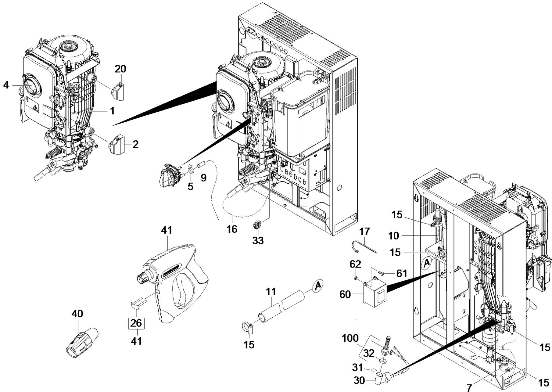
1000 ETL Pumpensatz kpl. HD 13/12-4 ST 400V (2.532-016.3)
