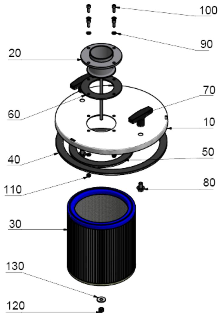
40 Deckel V2A, RA 20, komplett montiert (9.986-009.0)
