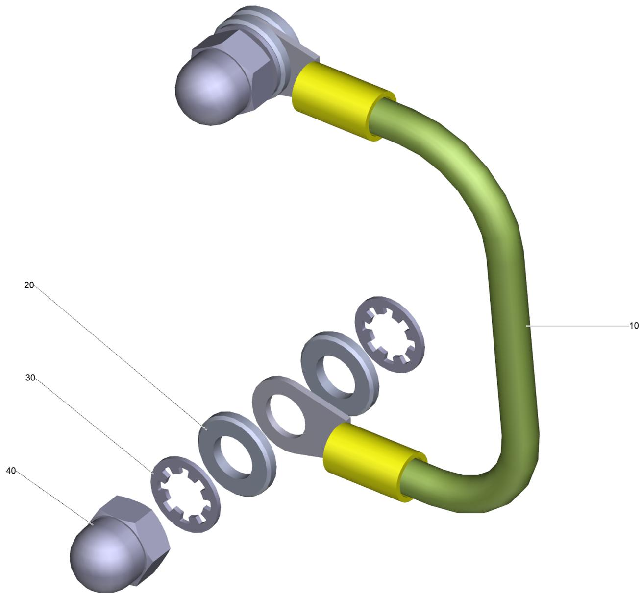
140 Erdungskabel Satz 150mm- 6<sup>2</sup> 2x Bolzen (9.981-539.0)
