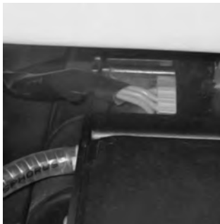
8 Włożyć kabel do przepustu izolowanego.
