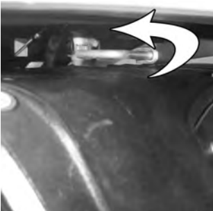
13 Zadrževalni sornik zavrtite 90° v levo do blokade.
