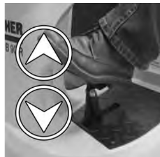
19 Controleren of de borstelkop juist ingehangen is: Bij het bedienen van het pedaal voor het optillen/neerlaten van de borstelkop moet deze vrij bewegen.
