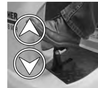
19 Comprobar si el cabezal del cepillo está colgado correctamente: Al pulsar el pedal para elevar/bajar el cabezal del cepillo, éste se tiene que poder mover libremente.
