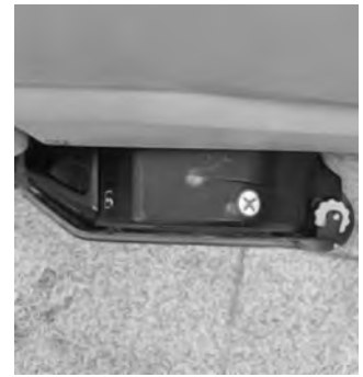
17 Orientare la testa della spazzola - Bordo esterno della testa della spazzola parallelo al telaio dell'apparecchio.
