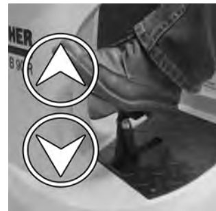
19 Kontroller at børstehodet er riktig festet: Når du bruker pedalen for løfting/senking av børstehodet skal den kunne bevege seg fritt.
