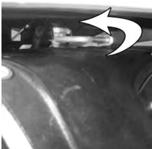
13 A tartószeget 90° -kal balra fordítani a rögzítés felé.
