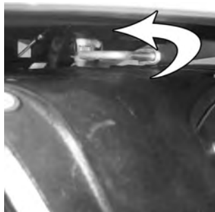
13 Vrid låsbulten 90° åt vänster för att låsa.
