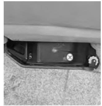
17 Rikta in borsthuvudet - borsthuvudets ytterkant ska vara parallell maskinens ram.
