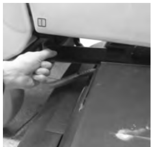
9 Zamknąć i zablokować osłonę.
