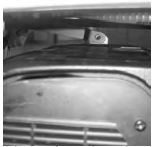
12 Posicionar a barra de apoio central na posição inferior e posicionar os pinos de retenção.
