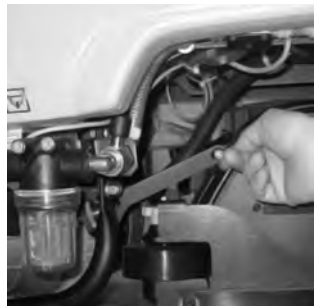
10 Seitliche Schubstangen nach oben drücken.
