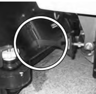
15 Vordere Zugstangen in die Führungsschlitze einführen.
