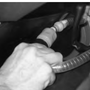
14 Vzpostavite vodni priključek.
