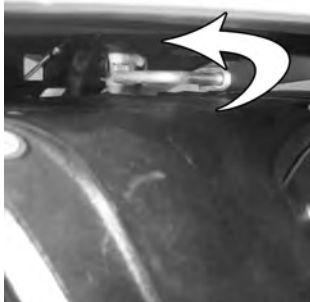
13 Lai fiksācijas tapu nofiksētu, pagrieziet to par 90° pa kreisi.
