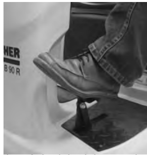
11 Docisnąć do dołu dolną powierzchnię pedału podnoszenia/opuszczania głowicy ssącej, wyhaczyć i pozwolić na powrót pedału do góry.
