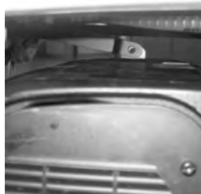
12 Vidējo turētājstieni novietojiet apakšējā pozīcijā un ievietojiet fiksācijas tapu.
