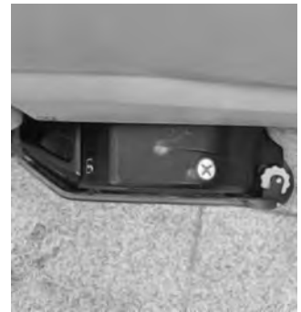
17 Juster børstehovedet - børstehovedets ydre kant parallel til maskinens ramme.
