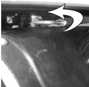
13 Haltebolzen um 90° nach links zur Arretierung drehen.
