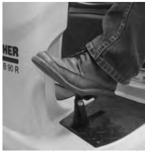
11 Achterste vlak van het pedaal voor het optillen / neerlaten van de reinigingskop naar beneden duwen, laten losspringen en pedaal naar boven laten gaan.
