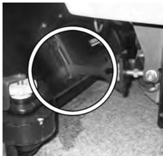
15 För in dragstängerna i styrlitarna
