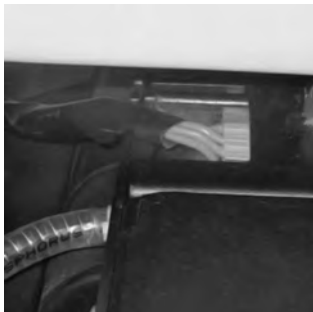
8 Legg kabelen i gjennomføringen.
