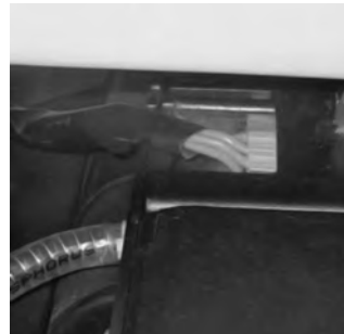
8 Posicionar o cabo na passagem.
