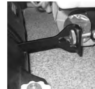
18 Apertar levemente os tirantes dianteiros, não fixar.
