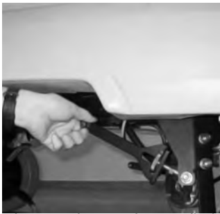
6 Deslocar as barras de tracção laterais para cima.
