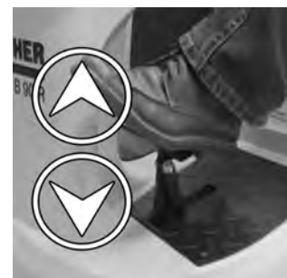
19 Sprawdzić, czy głowica szczotki jest właściwie zawieszona: Przy naciśnięciu pedału podnoszącego/opuszczającego głowicę szczotki musi się ona swobodnie poruszać.
