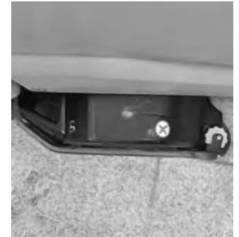
17 Bürstenkopf ausrichten - Außenkante Bürstenkopf parallel zum Geräterahmen.
