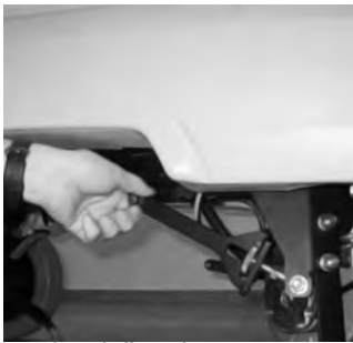
6 Stranske vlečne drogove premaknite navzgor.
