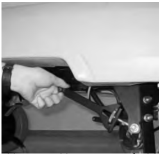
6 Trekk opp trekkstengene på siden.
