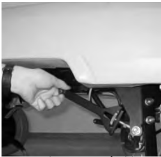
6 Bevæg trækstangen på siden opad.
