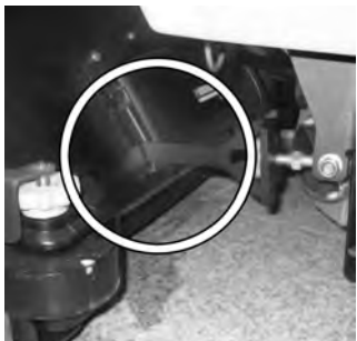
15 Før inn fremre trekkstang i føringssporet.
