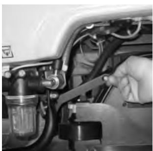
10 Docisnąć ku górze boczne łączniki przesuwne.
