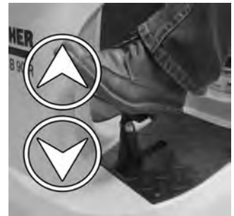
19 Kontroller, om børstehovedet er korrekt hængt ind: Hvis pedalet til løftning/sænkning af børstehovedet trædes, skal hovedet kunne bevæges frit.
