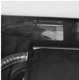
8 Ievietojiet kabeli atvērumā.
