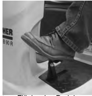
11 Hintere Fläche des Pedals zum Anheben/Absenken des Reinigungskopfs nach unten drücken, ausrasten und Pedal nach oben gehen lassen.
