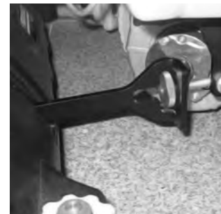
18 Lekko nakręcić przednie łączniki przesuwne, nie dociągać.
