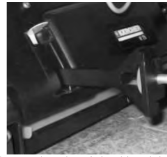
16 Ponownie założyć drążki ryglujące i docisnąć ku dołowi aż do zatrzaśnięcia.
