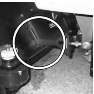
15 Inserir as barras de tracção dianteiras nas ranhuras de guia.
