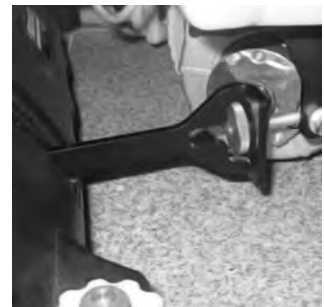
18 Lekko nakręcić przednie łączniki przesuwne, nie dociągać.
