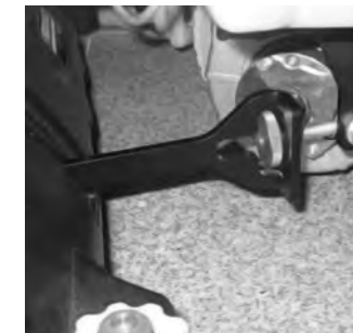
18 Sprednje premikalnike privijte, ne pritegnite.
