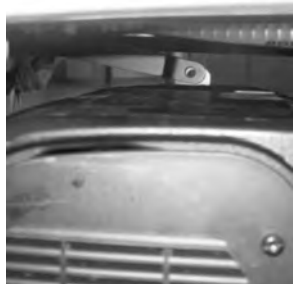
12 Sæt den midterste holdestang i nederste position og sæt holdebolten ind.
