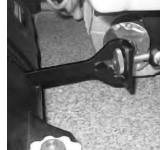
18 Pingutage eesmisi tõukevardaid kergelt - ärge pingutage tugevasti.
