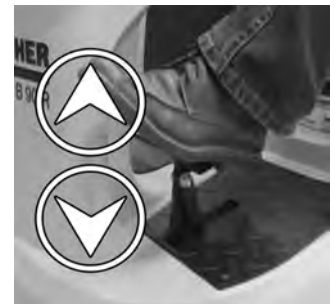
19 Controllare se la testa della spazzola è inserita correttamente: Quando si aziona il pedale per sollevare/abbassare la testa della spazzola, questa deve spostarsi liberamente.
