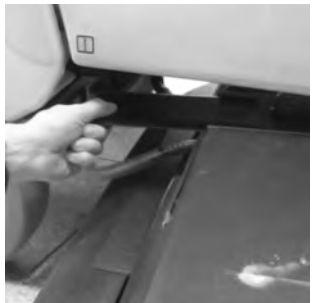
9 Zamknąć i zablokować osłonę.
