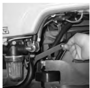
10 Împingeți barele de deplasare laterale în sus.
