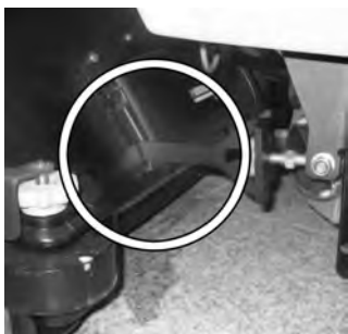
15 Før inn fremre trekkstang i føringssporet.
