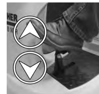
19 Verificar se a cabeça de escova está correctamente engatada: Ao accionar o pedal para elevar/baixar a cabeça de escova, esta deve deslocar-se facilmente.
