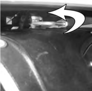
13 Przekręcić trzpień podtrzymujący o 90° na lewo w celu jego zablokowania.
