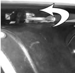
13 Faire tourner l'axe de retenue de 90° vers la gauche pour le bloquer.
