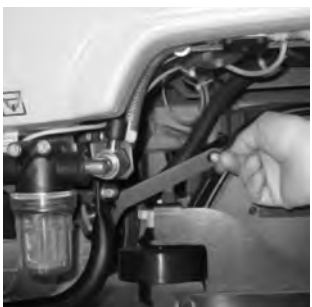
10 Docisnąć ku górze boczne łączniki przesuwne.
