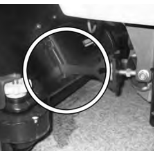
15 Introdurre i tiranti anteriori nella fessura di guida.
