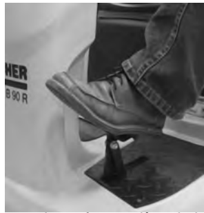
11 Pousser la surface arrière de la pédale pour lever/abaisser la tête de nettoyage vers le bas, sortir la pédale du cran et la laisser remonter vers le haut.
