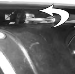
13 Rodar o pino de retenção em 90° para a esquerda até engatar.
