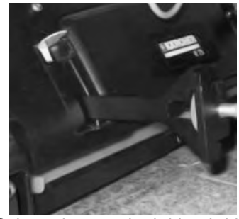
16 Colocar de nuevo las bridas de bloqueo y presionar hacia abajo hasta que encajen.
