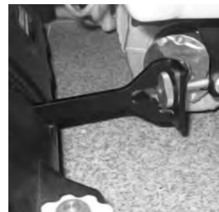
18 Strângeți ușor barele de deplasare din față, aveți grijă să nu le strângeți prea tare.
