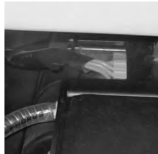
8 Poser le câble dans le passe-câble.
