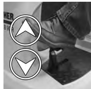
19 Kontroller, om børstehovedet er korrekt hængt ind: Hvis pedalet til løftning/sænkning af børstehovedet trædes, skal hovedet kunne bevæges frit.
