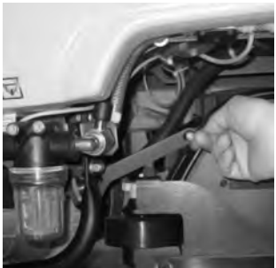
10 Presionar hacia arriba las barras de empuje laterales.
