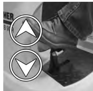
19 Controleren of de borstelkop juist ingehangen is: Bij het bedienen van het pedaal voor het optillen/neerlaten van de borstelkop moet deze vrij bewegen.
