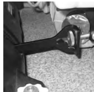
18 Voorste duwstangen licht aanspannen, niet vastzetten.
