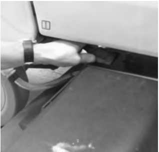
7 Insertar firmemente la conexión insertable.
