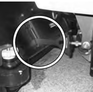
15 Vordere Zugstangen in die Führungsschlitze einführen.
