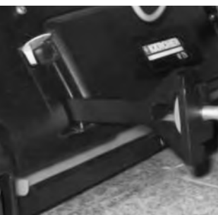
16 A reteszelő füleket ismét behelyezni és bepattanásig lefelé nyomni.
