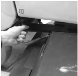
9 Cerrar y bloquear la cubierta.
