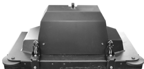
Смонтированный передний держатель на вибрационной головке S65
