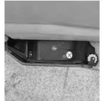
17 Aligner la tête de brosse - bord extérieur de la tête de brosse parallèle au cadre de l'appareil.
