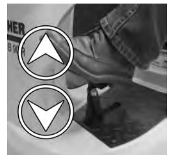
19 Kontrollera om borsthuvudet är rätt ihak: När man trycker på pedalerna för att lyfta/sänka borsthuvudet måste det röra sig fritt.
