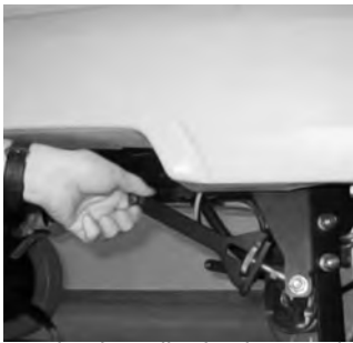
6 Mover hacia arriba las barras de tracción laterales.
