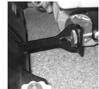
18 Vordere Schubstangen leicht anziehen, nicht festziehen.
