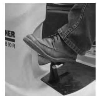
10 Spingere verso l'alto le aste di spinta laterali.
