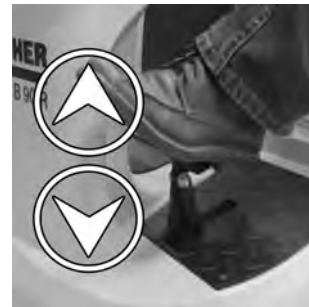
19 Kontroller, om børstehovedet er korrekt hængt ind: Hvis pedalet til løftning/sænkning af børstehovedet trædes, skal hovedet kunne bevæges frit.
