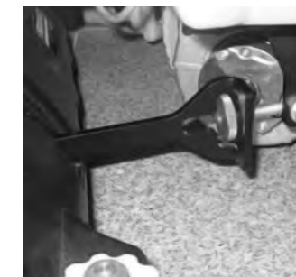
18 Voorste duwstangen licht aanspannen, niet vastzetten.
