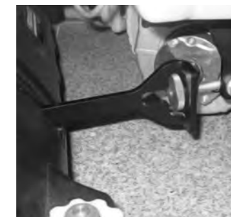
18 Sprednje premikalnike privijte, ne pritegnite.
