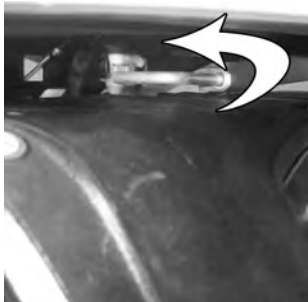
13 Haltebolzen um 90° nach links zur Arretierung drehen.
