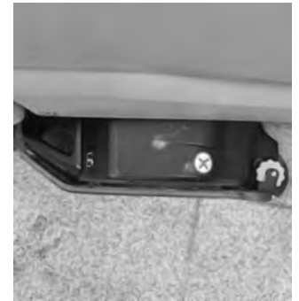
17 Ustawić głowicę szczotki - Boczna krawędź głowicy szczotki równoległe do ramy urządzenia.
