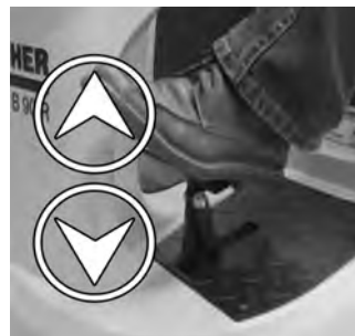
19 Comprobar si el cabezal del cepillo está colgado correctamente: Al pulsar el pedal para elevar/bajar el cabezal del cepillo, éste se tiene que poder mover libremente.
