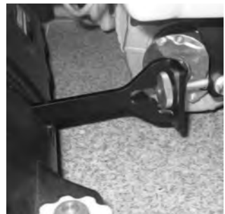
18 Apretar las barras de empuje delanteras ligeramente, no apretar en exceso.
