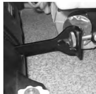
18 Trekk lett i fremre skyvestang, ikke trekk den i lås.
