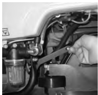
10 Seitliche Schubstangen nach oben drücken.
