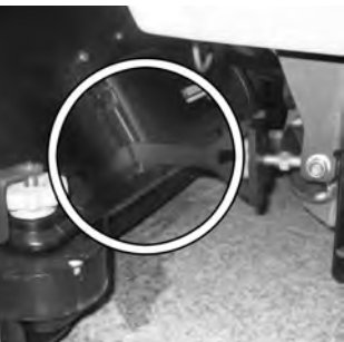
15 Før de forreste trækstænger ind i styringslidserne.
