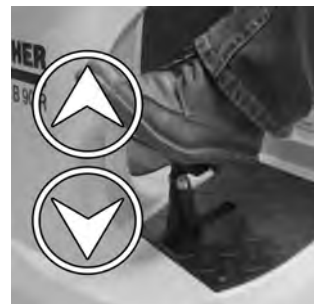
19 Kontrollige, kas harjapea on õigesti kin- nitatud: Kui vajutada pedaalile harjapea tõstmiseks/langetamiseks, peab see vabalt liikuma.
