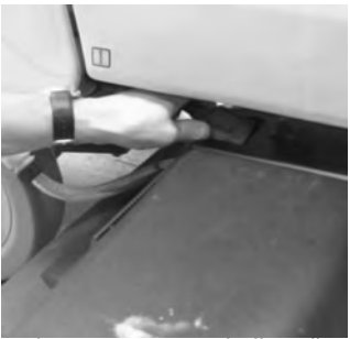
7 Encaixar o conector de ligação.
