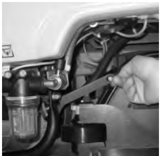
10 Pritisnite bočne potisne šipke prema gore.
