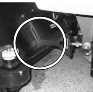
15 Vordere Zugstangen in die Führungsschlitze einführen.
