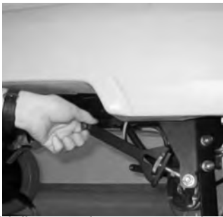
6 Zijdelingse trekstangen naar boven bewegen.
