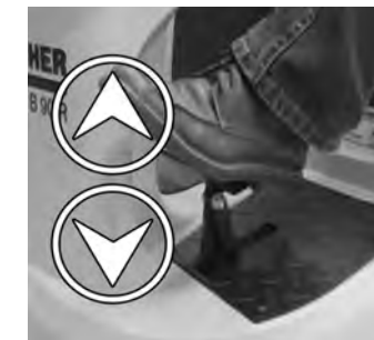
19 Vérifier si la tête de brosse est correctement accrochée : lors de l'actionnement de la pédale pour lever/abaisser la tête de brosse, cette dernière doit se déplacer librement.
