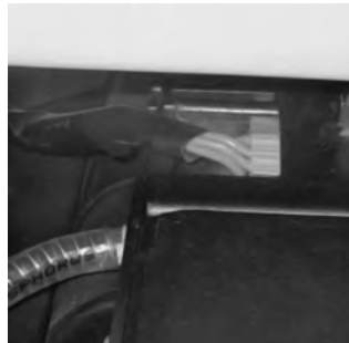
8 Kabel in die Durchführung einlegen.
