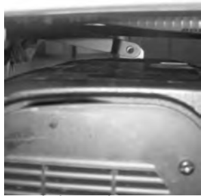
12 Amener la barre de retenue centrale dans la position inférieure et mettre l'axe de retenue en place.
