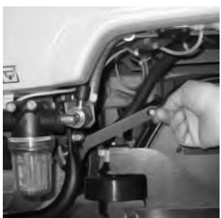
10 Docisnąć ku górze boczne łączniki przesuwne.
