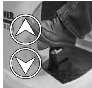
19 Controllare se la testa della spazzola è inserita correttamente: Quando si aziona il pedale per sollevare/abbassare la testa della spazzola, questa deve spostarsi liberamente.
