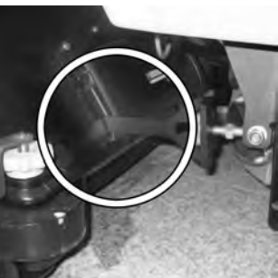
15 Voorste trekstangen in de geleidings-sleuf brengen.
