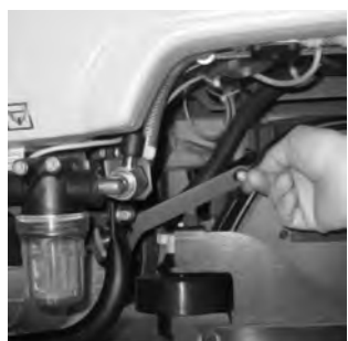
10 Seitliche Schubstangen nach oben drücken.
