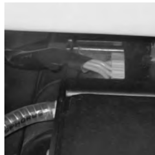
8 Kabel položite v vodilo.
