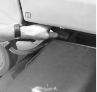
7 Inserire la spina di collegamento.
