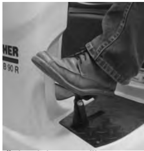
11 Stražnju plohu papučice za podizanje/spuštanje bloka čistača pritisnite prema dolje, deblokirajte i pustite da se papučica podigne.
