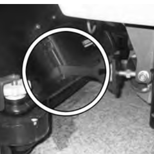
15 Vordere Zugstangen in die Führungsschlitze einführen.
