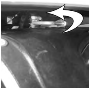
13 Vrid låsbulten 90° åt vänster för att låsa.
