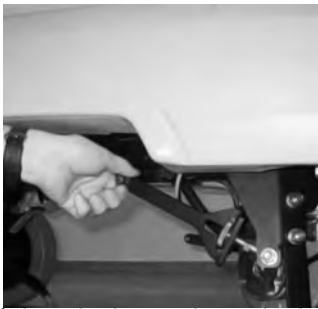
6 Déplacer les barres de traction latérales vers le haut.
