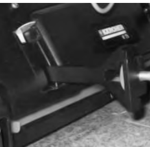
16 Sätt i låstungorna igen och tryck neråt till det låser.
