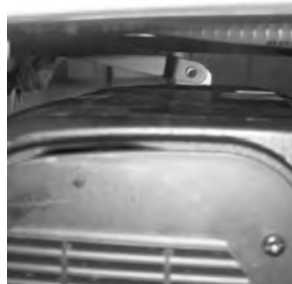
12 För den mittre stödstången till undre position och sätt i låsbulten.
