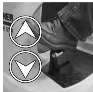
19 Provjera ispravnog položaja bloka četki: Prilikom pritiska na papučicu radi podizanja/spuštanja bloka četki, ona mora biti slobodno pokretljiva.
