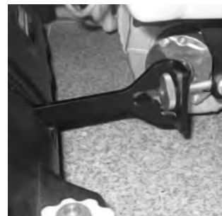
18 Trekk lett i fremre skyvestang, ikke trekk den i lås.
