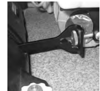
18 Serrer légèrement les barres de traction avant sans les serrer à fond.
