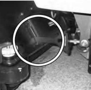
15 Før de forreste trækstænger ind i styringslidserne.
