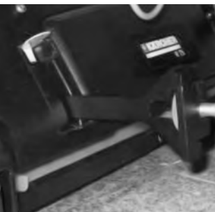
16 Sett på igjen låsene og trykk ned til de går i lås.
