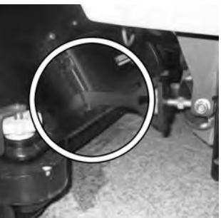
15 Voorste trekstangen in de geleidings-sleuf brengen.
