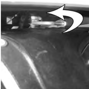
13 Til låsning drejes holdebolten 90° til venstre.
