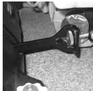
18 Voorste duwstangen licht aanspannen, niet vastzetten.
