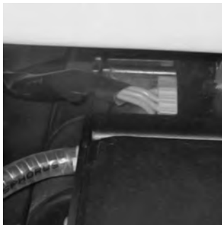
8 Włożyć kabel do przepustu izolowanego.
