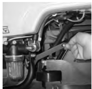
10 Presser les barres de poussée latérales vers le haut.
