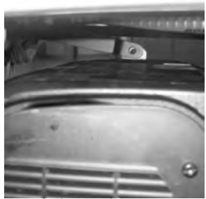
12 Amener la barre de retenue centrale dans la position inférieure et mettre l'axe de retenue en place.
