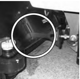
15 Introduire les barres de traction avant dans la fente de guidage.
