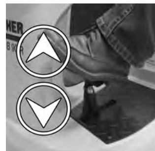
19 Provera ispravnog položaja bloka četki: Prilikom pritiska na pedalu radi podizanja/spuštanja bloka četki, ona mora biti slobodno pokretljiva.
