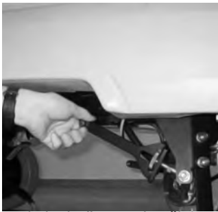
6 Pomaknite bočne spojne šipke prema gore.
