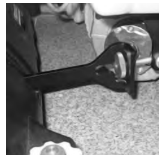
18 Lagano zavijte prednje potisne šipke, nemojte ih pritezati.
