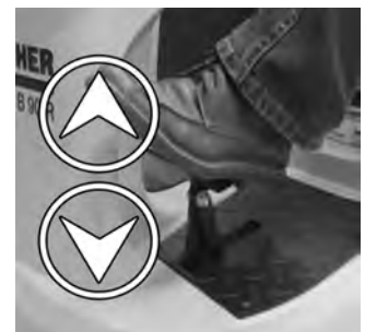
19 Kontrollera om borsthuvudet är rätt ihakat: När man trycker på pedalerna för att lyfta/sänka borsthuvudet måste det röra sig fritt.
