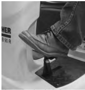
11 Presionar hacia abajo la superficie trasera del pedal para elevar/bajar el cabezal de limpieza, desencajar y dejar que el pedal vaya hacia arriba.
