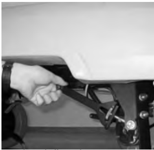
6 Stranske vlečne drogove premaknite navzgor.
