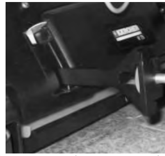
16 Ponovno vstavite zaporne vezice in jih pritisnite navzdol dokler se ne zaskočijo.
