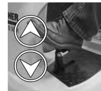
19 Prüfen ob der Bürstenkopf richtig eingehängt ist: Beim Betätigen des Pedals zum Anheben/Absenken des Bürstenkopfs, muss dieser sich frei bewegen.
