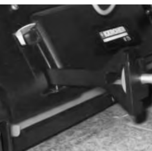
16 Ponovo postavite blokirne jezičke i pritisnite na dole tako da se uglave.
