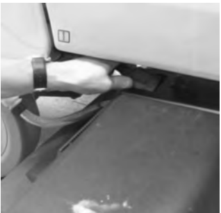
7 Verbindingsstekker vast insteken.
