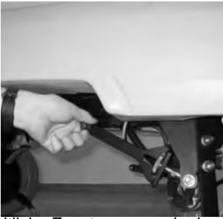
6 Seitliche Zugstangen nach oben bewegen.
