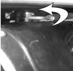
13 Haltebolzen um 90° nach links zur Arretierung drehen.
