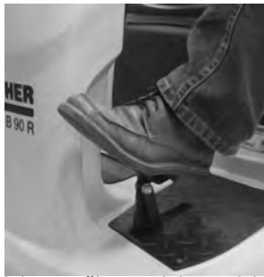
11 Zadnjo površino pedala za dviganje/spuščanje čistilne glave pritisnite navzdol, izskočite in pustite, da se pedal dvigne navzgor.
