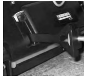
16 Ponownie założyć drążki ryglujące i docisnąć ku dołowi aż do zatrzaśnięcia.
