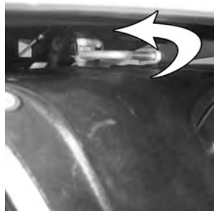
13 Vrid låsbulten 90° åt vänster för att låsa.
