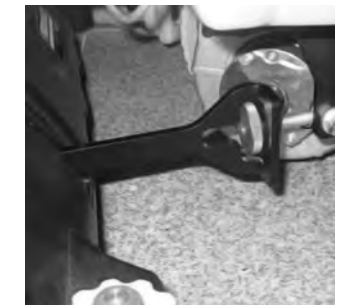
18 Apretar las barras de empuje delanteras ligeramente, no apretar en exceso.
