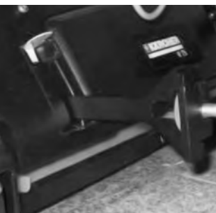
16 Inserire nuovamente le fascette di bloccaggio e premere in basso fino all'aggancio.
