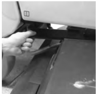
9 Zaprite pokrov in ga blokirajte.
