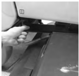
9 Zamknąć i zablokować osłonę.
