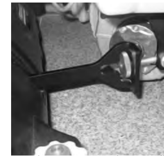
18 Apertar levemente os tirantes dianteiros, não fixar.
