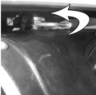
13 Faire tourner l'axe de retenue de 90° vers la gauche pour le bloquer.
