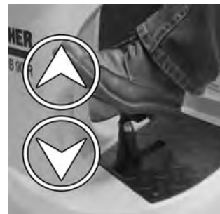
19 Verificați dacă capul de perie este bine agățat. La acționarea pedalei pentru ridicarea/coborârea capului de perie, acesta trebuie să se miște liber.
