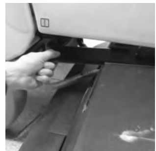
9 Fermer et verrouiller le couvercle.
