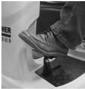
11 Pressionar a superfície traseira do pedal (para levantar/baixar a cabeça de limpeza) para baixo, desengatar e permitir a subida do pedal.
