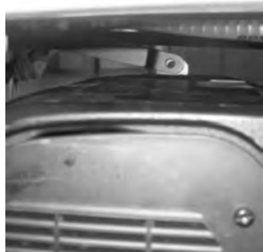
12 Colocar la barra de sujeción central en la posición inferior y colocar el perno de sujeción.
