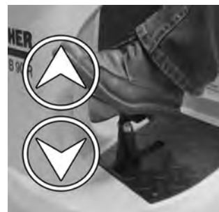
19 Ellenőrizze, hogy a kefej jól be van-e akasztva: A kefej megemelése/leeresztése pedál működtetése esetén ennek szabadon kell mozognia.
