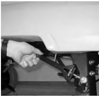
6 Pomerite bočne spojne šipke na gore.
