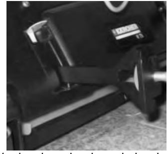
16 Verriegelungslaschen wieder einsetzen und bis zum Einrasten nach unten drücken.
