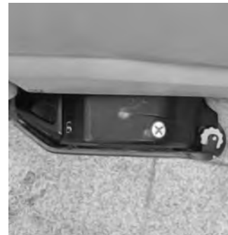
17 Borstelkop uitrichten - buitenkant borstelkop parallel aan het frame van het apparaat.
