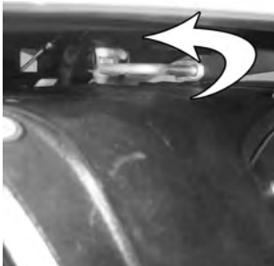
13 Stabilizacioni sprežnjak okrenite za 90° ulevo kako biste blokirali.
