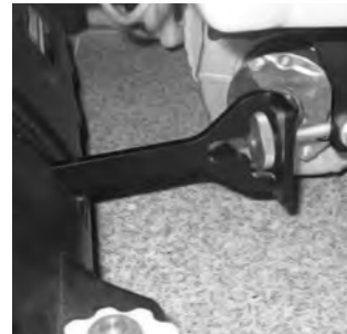
18 Pingutage eesmisi tõukevardaid kergelt - ärge pingutage tugevasti.
