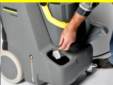
A Deckel des Frischwassertanks öffnen.
